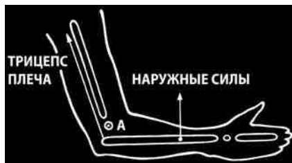
Рис. 2.34. Рычаг первого рода в теле человека. Сила трехглавой мышцы плеча, действующая на локтевой отросток локтевой кости, и внешняя сила, действующая на локтевую кость, разделены осью (А)
